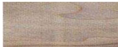
\* ステッカーマークは棧の後が残る欠点です。表面だけでなく削っても残る欠点です。アメリカ産の現地挽きは日本の様な四角い棧ではなくスクリュウの様な棧もしくは金属製のH型の棧を入れ、製材後木に負担が少し残る生材から人工乾燥を施す事で防いでいます。服部商店の裏技は、現地のやり方の良い所だけ取った特別な方法です。
