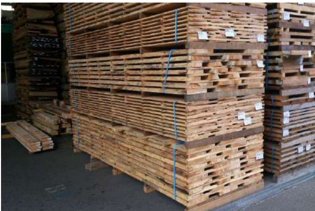
約10日間再び天然乾燥を施す
