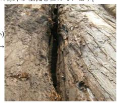
そして買い付けしてからしか解からないケースが本当に多くなって来ています。製材の前に皮を剥くのですが、剥くと目新しいキズが現れのです。これは服部用語では『枝落ち』と言う表現をしていますが、部分的に腐っているのです。枝落ちとは二三十年かもう少し昔に枝が落ちます。そしてそこに穴が開きます。その穴から水が本体に浸み込むのですが、成長していく過程で皮が表面を覆ってくるのです。買い付け時に見つけられないのです。原木を引き取って全体を細かく見れば枝落ちの場所は解かりますが木材展示場で発見するのは不可能だと思います。次に枝落ちの無い原木でも新たな欠点が出現します。それは以前とは全く違う欠点です。死節が凄く多いのです。木は成長します。成長する為に枝を伸ばします。節は枝です。節が無かったら木では無いので有って当たり前ですが、節を避ける様に製材するのですが、節が死んでいる為にキズを避けきれないのです。最近製材した直径50センチの原木で言えば皮から10センチ位だけが使えるだけで中は節と節からの水割れで何も取れない材質の原木にも出合いました。
