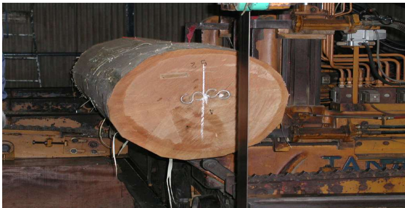
上記写真はカツラ原木を製材している様子です。
