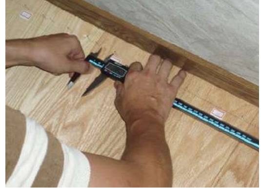
床の形状変化を毎日四回測定する
